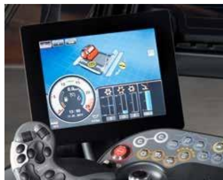
Зapatентованный iTerminal с оптимизированным руководством благодаря цветовому выделению активных компонентов.
