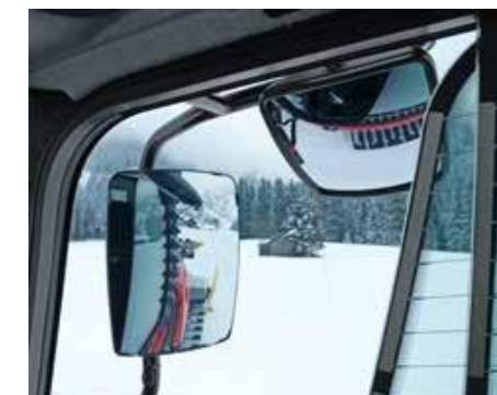
Горизонтальное зеркало обеспечивает прямой обзор гусениц.
