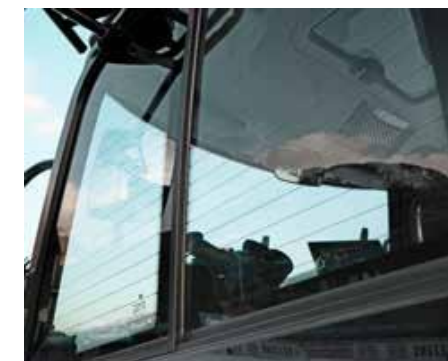
Двойные раздвижные боковые окна, обогреваемые и в открытом положении, для оптимального бокового обзора.
