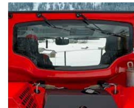
Увеличенное обогреваемое заднее стекло для оптимального заднего обзора.
