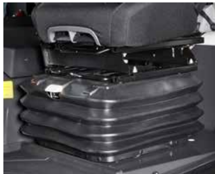
Сиденье с прочной рамой на пневмоподвеске для безопасной работы и повышенного комфорта при работе.
