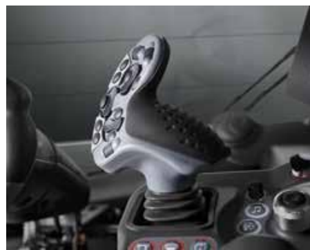
Джойстик с эргономичным и пропорциональным управлением для интуитивной работы.
