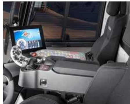
Оптимальное управление даже на пересеченной местности благодаря блоку управления, встроенному в сиденье.
