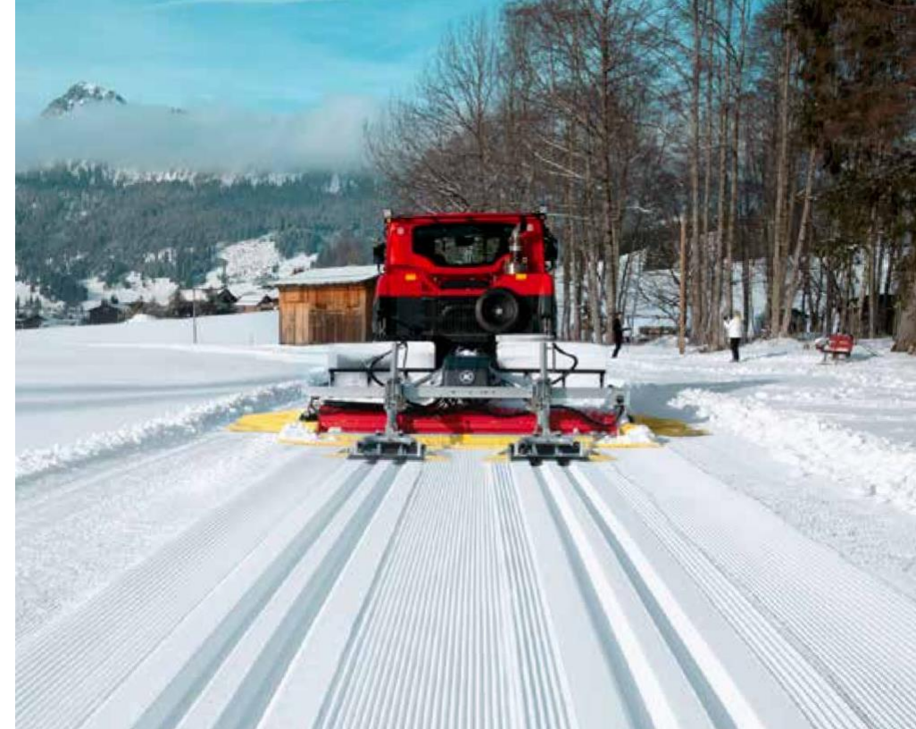
Регулируемый двухполосный лыженарезчик Двухполосный лыженарезчик с гидравлической регулировкой с одной стороны
